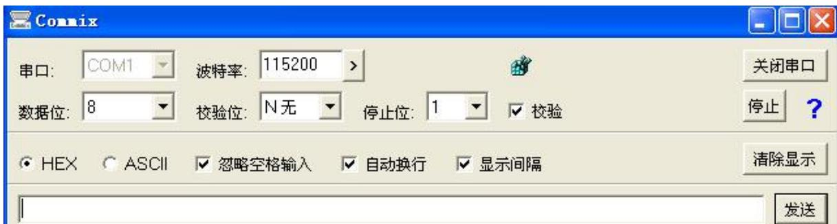
出厂设置波特率一般是 115200，校验勾上，选择 CRC16（Modbus RTU）校验方式
