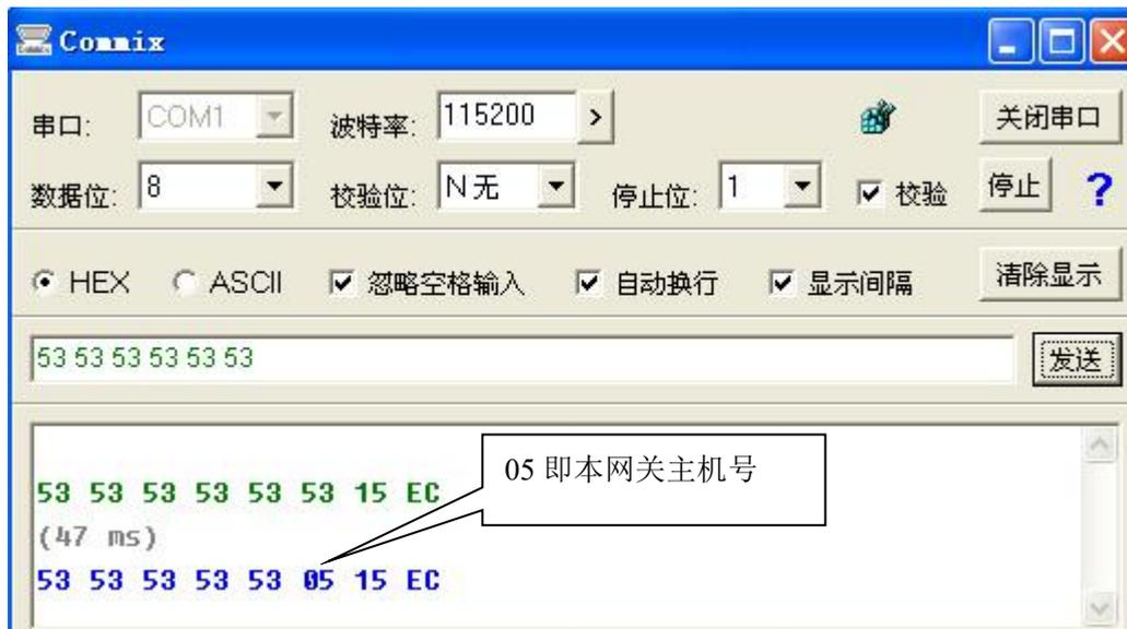
有蓝色数据回复说明无线网关及通讯线路正常。否则需断电检查通讯线是否接错。网关正常工作时 POWER 灯常亮，
